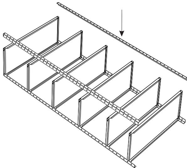
Parafuse o restante das Prateleiras distanciando-as conforme a necessidade e em seguida coloque as duas colunas para finalizar a montagem. Só então faça o aperto geral dos parafusos.
