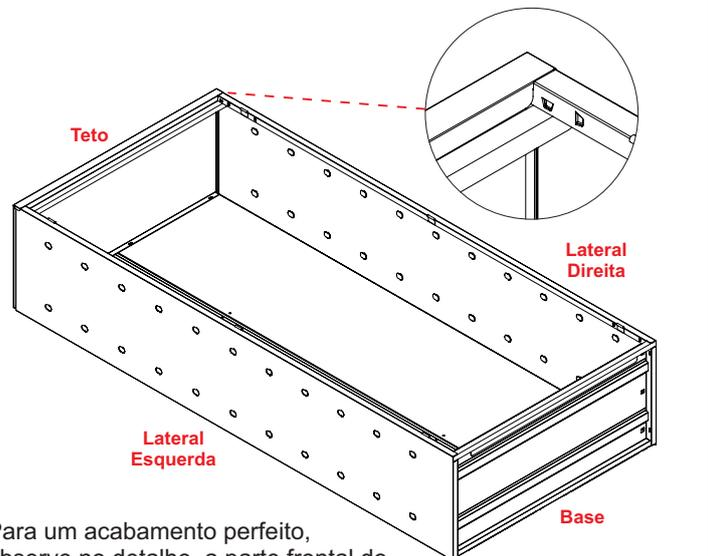
Para um acabamento perfeito, observe no detalhe, a parte frontal do teto deve encaixar nos rasgos existentes nas laterais.
