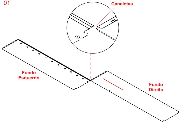
Inicie fazendo a união do fundo direito e esquerdo, encaixando as canaletas e deslizando até o final, deixando-os em paralelo.
