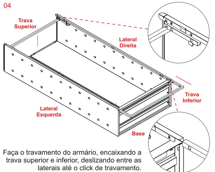
Faça o travamento do armário, encaixando a trava superior e inferior, deslizando entre as laterais até o click de travamento.
