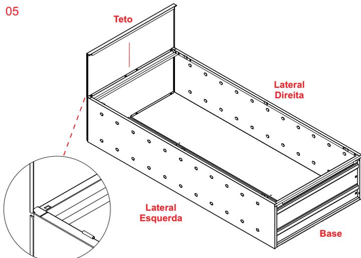
Encaixe o teto nas canaletas existentes nas laterais e deslize até o final.
