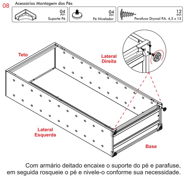
Com armário deitado encaixe o suporte do pé e parafuse, em seguida rosqueie o pé e nivele-o conforme sua necessidade.
