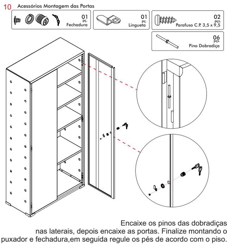
Encaixe os pinos das dobradiças nas laterais, depois encaixe as portas. Finalize montando o puxador e fechadura, em seguida regule os pés de acordo com o piso.
