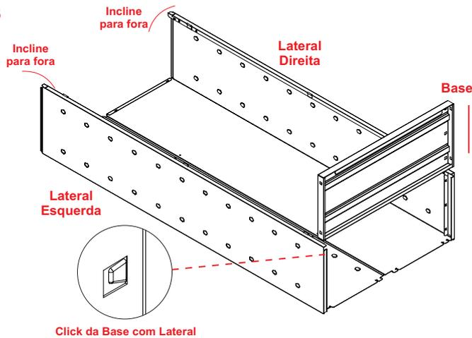
Incline as laterais para fora de forma que possa encaixar a base, certifique-se que esteja bem posicionada, em seguida, pressione a lateral direita e esquerda contra a base, certificando que estão clicadas e bem travadas.
