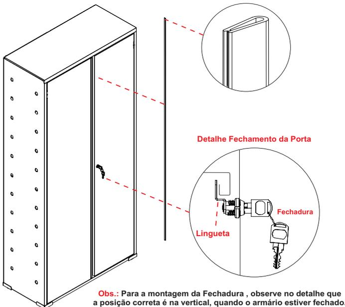
**Obs.:** Para a montagem da Fechadura, observe no detalhe que a posição correta é na vertical, quando o armário estiver fechado.
