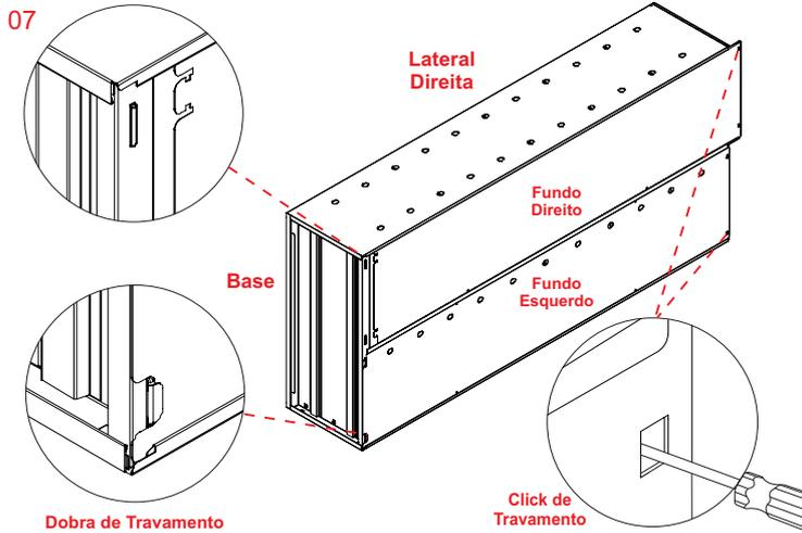
Vire o armário, depois finalize encaixando o fundo com a base e teto. Com auxílio de uma chave philips, empurre os clicks superiores para dentro e dobre, em seguida dobre a trava do fundo com a base de forma que fiquem bem travadas. Conforme mostra o detalhe.
