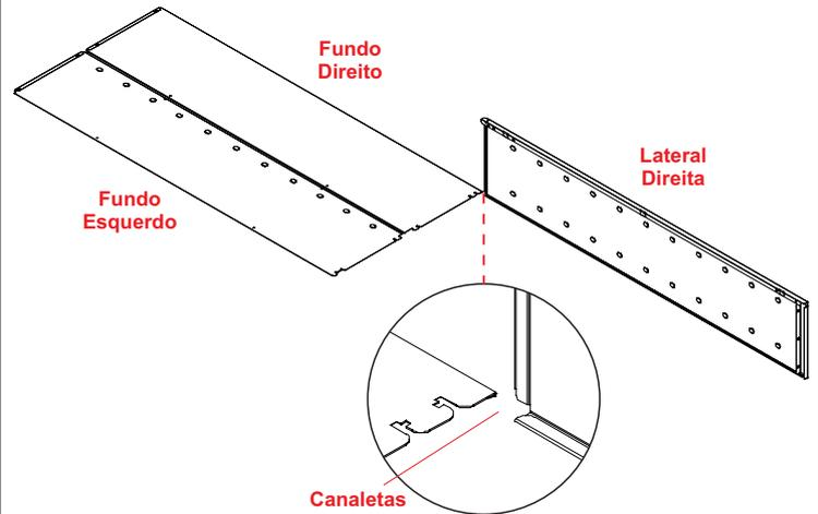
Encaixe a canaleta da lateral direita com a do fundo direito, conforme detalhe e deslize até o final. Em seguida faça o mesmo com o lado esquerdo.
